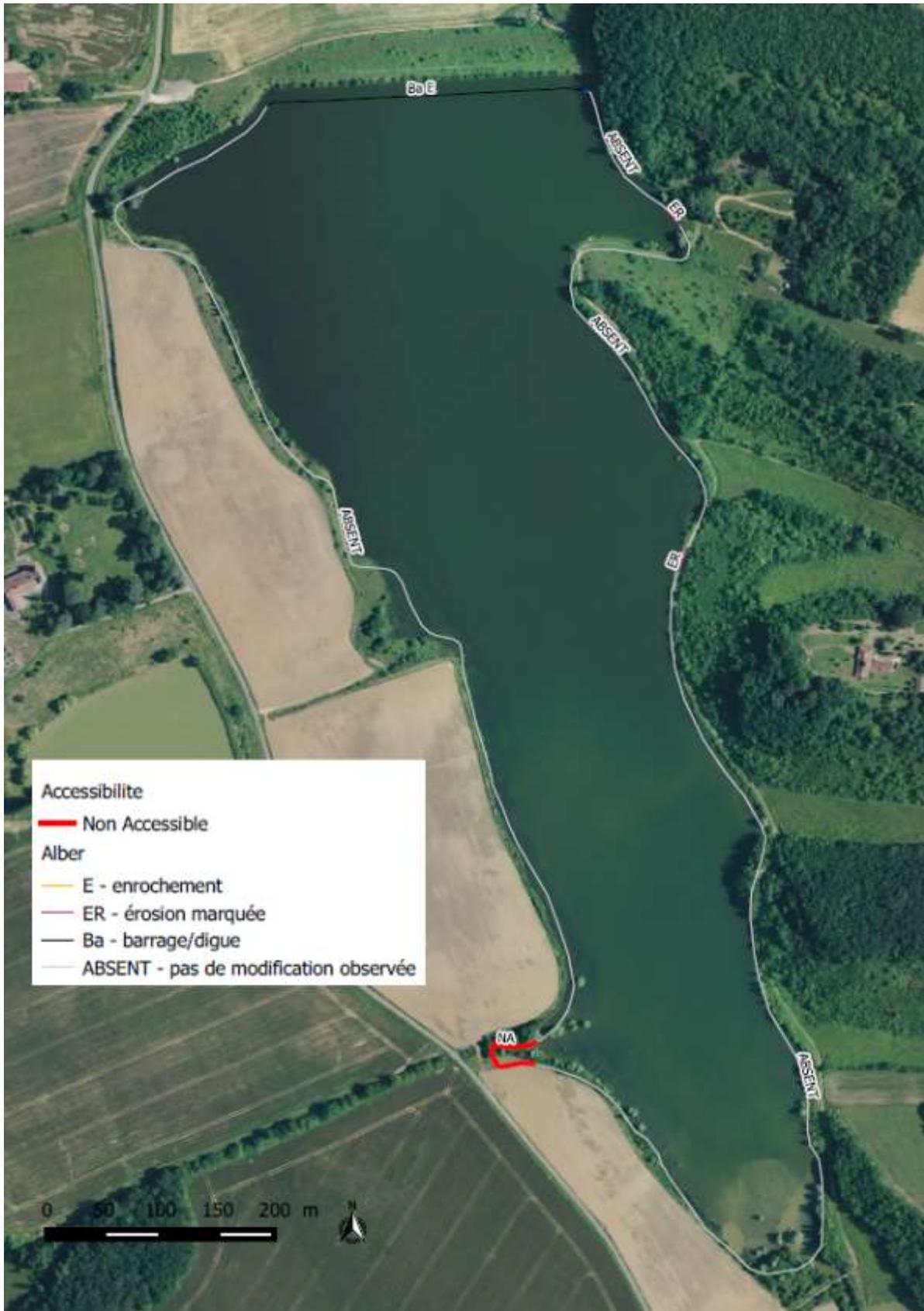
Figure 25 : Altérations des berges relevées sur le plan d'eau de la Castagnère
